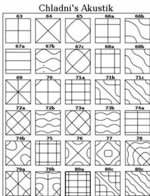
**Figura 2. Figuras de Chladni creadas por arena fina sobre una placa cuadrada al hacerla vibrar por un sonido Fuente: Wikimedia Commons.**
