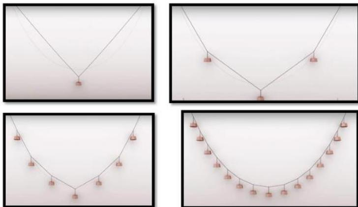
**Imagen 6.** Explicación gráfica de cómo se forma la curva catenaria a partir de la unión de dos rectas: a medida que se añaden peses se va creando la curva, al ir acortando la distancia entre los puntos superiores se consiguen diferentes curvas Fuente: Martín Tavio (2017:21)
