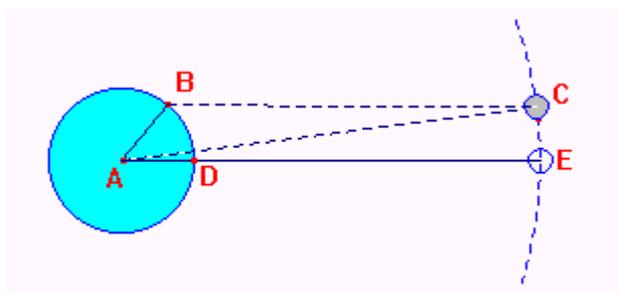
Por observação direta o ângulo  $\alpha$  pode ser obtido. Nesse caso com  $t = 4$  horas teremos  $\alpha = 58,8^\circ$ . Conseqüentemente  $\beta = 121,2^\circ$  e  $m(BCA) = 0,8^\circ$
